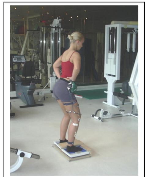
Abb.26: Befestigung der Kabel mithilfe elastischer Bänder und Tapes
