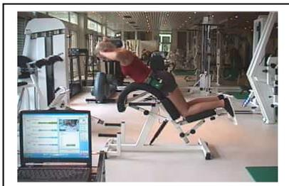
Abb. 80: Typische Testanordnung und Befunde für eine statische EMG-Rückentestung: Mediane (A) u. mittlere Frequenz (B), Nullliniendurchgang (C) und mittlere Amplitude (D), Abfall bei einer trainierten (grün) und untrainierten (blau) Person, gemessen am Multifidus-Muskel.
