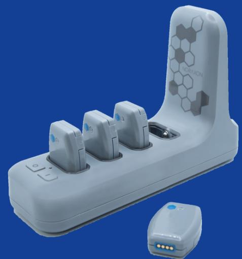
Das System ist für eine Messkonfiguration von bis zu 4 drahtlosen Sensoren ausgelegt und erfasst Daten bei 2.000 Hz für mehr als 4 Stunden
